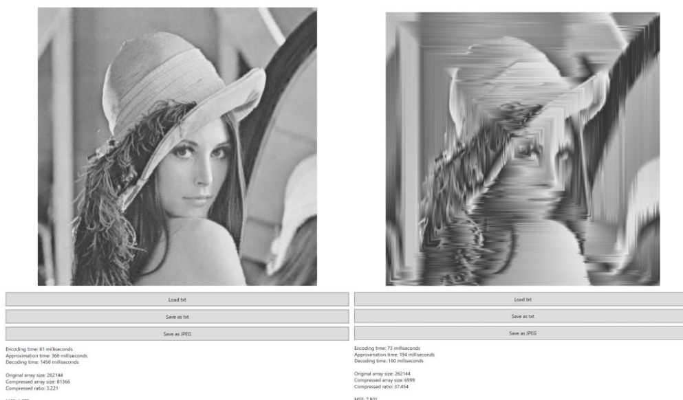
Рис. 2. Результати стиснення за алгоритмом Рамера-Дугласа-Пакера з точністю наближення 2 (а) та 32 (б)
