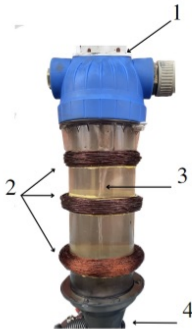
Рисунок 1. Робоча камера групування домішок рідини: 1 – вузол вводу рідини; 2 – соленоїди, 3 – параболоїд групування домішок; 4 – днище РКГ з центральним отвором видалення домішок з рідини.
