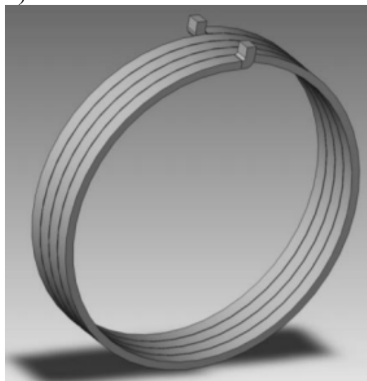
Рис. 1 Зовнішній вигляд моделей охолоджуючої сорочки (а) типової та (б) спіральної
