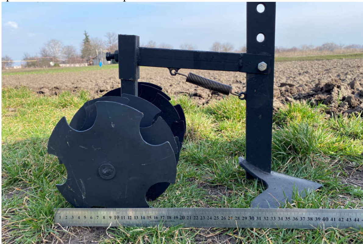
Рисунок 2 – дослідний зразок модульного ґрунтообробного робочого органу.
