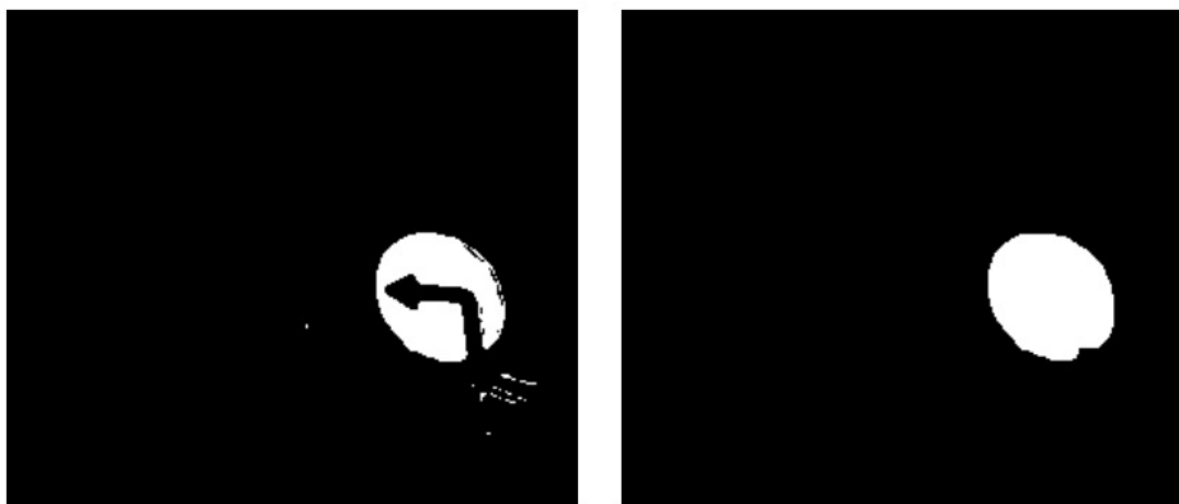
Рис.1. Виділення області знака (зліва - до застосування морфологічних операцій; праворуч - після застосування морфологічних операцій)
