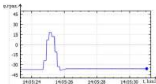
Рисунок 2 – перехідна характеристика системи автоматичної стабілізації поперечної осі бікоптеру (реакція системи на збурювальний вплив)
