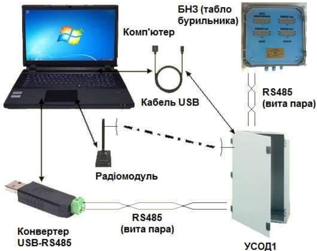
Рис. 1. Комп'ютерна система ідентифікації станів бурової установки на основі системи СКУБ М2-00
