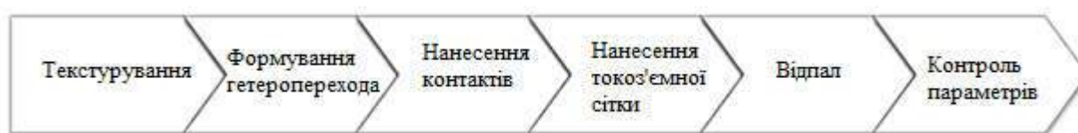
Рис. 2. Технологічний маршрут виготовлення гетероструктурних сонячних елементів.
