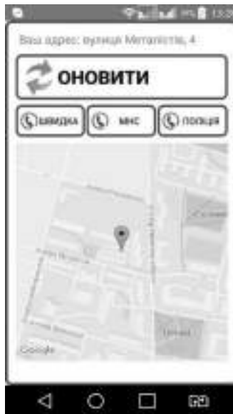
Рис. 1- Інтерфейс модулю визначення місцеположення користувача та набору екстрених номерів
