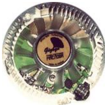
Рис. 1. Мікропроцесорний модуль локального охолодження «Smart Cooler»
