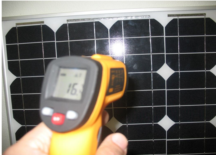
Рис. 1. Вимірювання температури поверхні сонячної панелі пірометром
