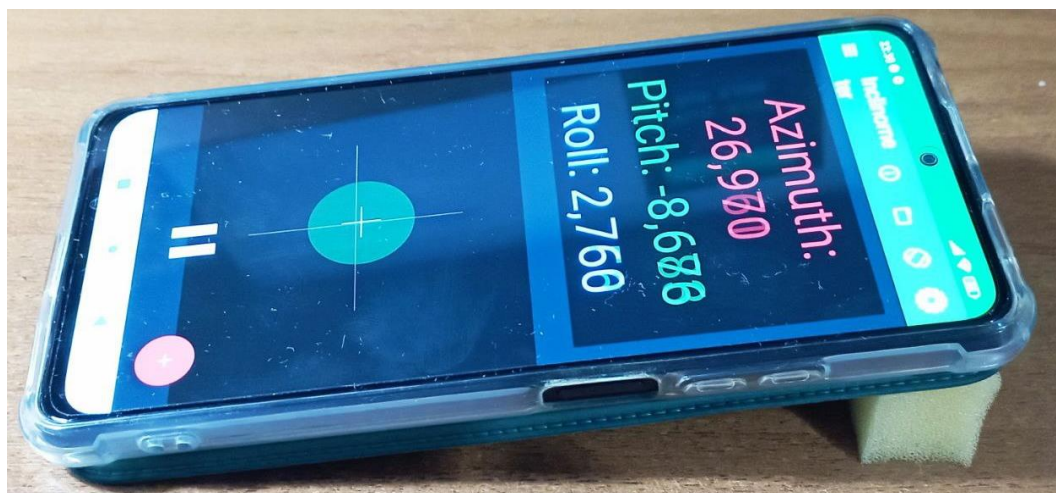
Рис. 2. Вимірювання нахилу смартфона за допомогою програми «PhysicsToolboxSuite»
