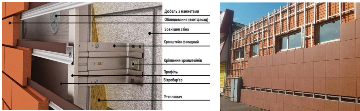
Рис.1. Схема кріплення вентилязованого фасаду до стіни
