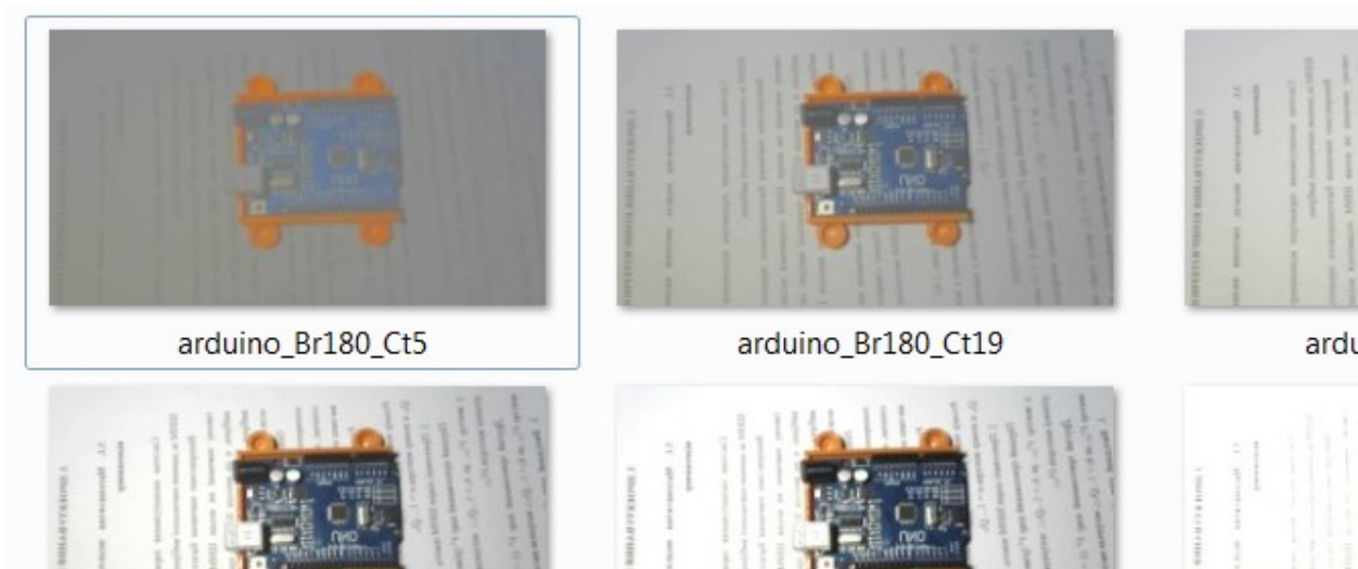
Рис. 1. Фрагмент серії зображень пристрою Arduino UNO, отриманих відеокамерою «Logitech HD Webcam C270» для високої освітленості об’єктів (660 люкс); значення параметру «Яскравість» рівне 180; значення параметру «Контраст» змінюється від 5 до 59
