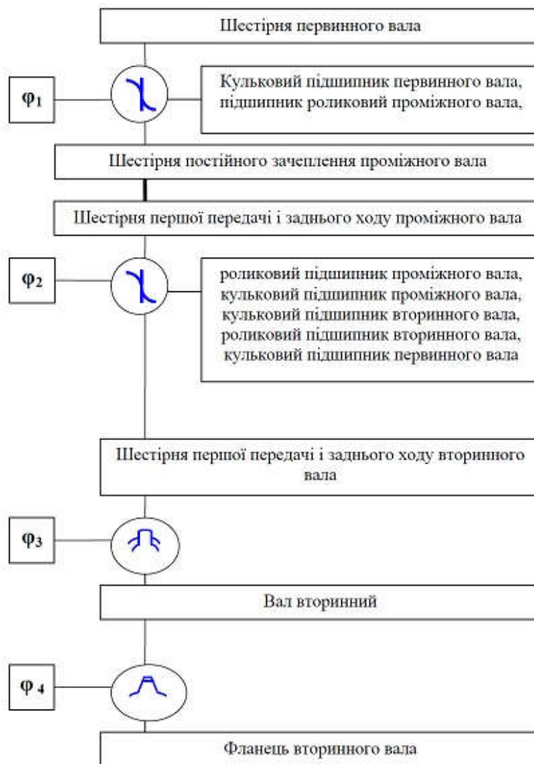
Рис. 2. Структурна модель контактів деталей при ввімкненні першої передачі з відображенням типу контакту, в якому виникає зазор та переліку деталей технічний стан яких опосередковано (побічно) впливає на кутовий люфт \varphi
