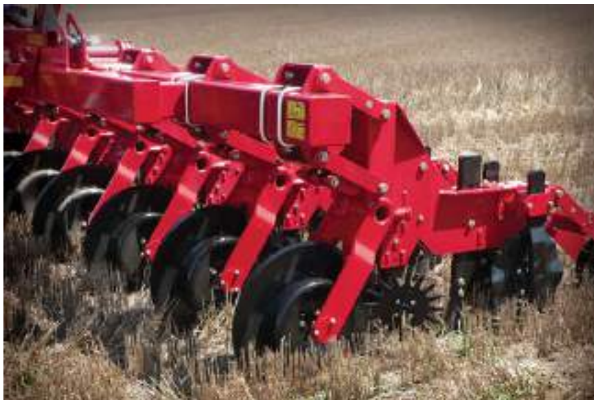
Рисунок 1.5 – Секція ротаційної борони в складі комбінованого ґрунтообробного агрегату: 1 – рама; 2 – колтер; 3 – секція ротаційної борони; 4 – секція турбодискова; 5 – долотоподібний глибокорозпушувач.
