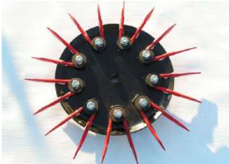
Рисунок 1.4 – Колесо з декількох складових одиниць. (легка борона): 1 – голка; 2 – диск; 3 – елементи кріплення.
