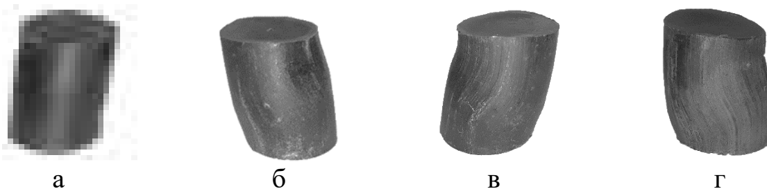
Рис. 2 – Загальний вигляд зразків після стиснення фенілоу С-2 (а), та композитів на його основі, наповнених 5(б); 10(в); 15(г) мас. % карбиду бора
