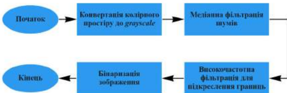
Рис. 3. Алгоритм попередньої обробки зображення перед розпізнаванням тексту
