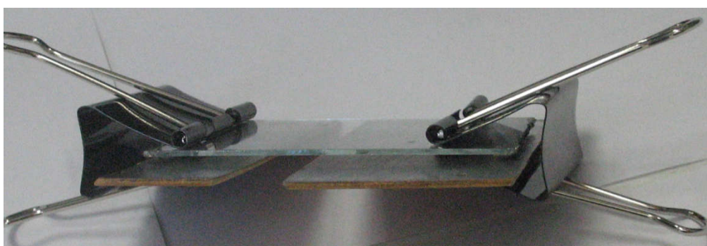
Рис.2 – Притискання еластичних контактів до скла із нанесеним шаром ІТО і металізованої поверхні плат друкованого монтажу
