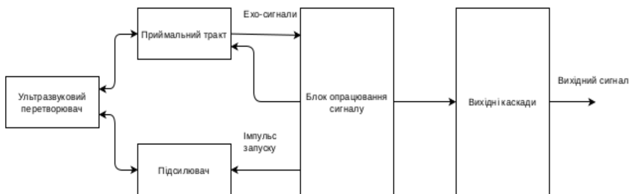
Рис.1 Типова блок-схема ультразвукового датчика з суміщеними випромінювачем і приймачем
