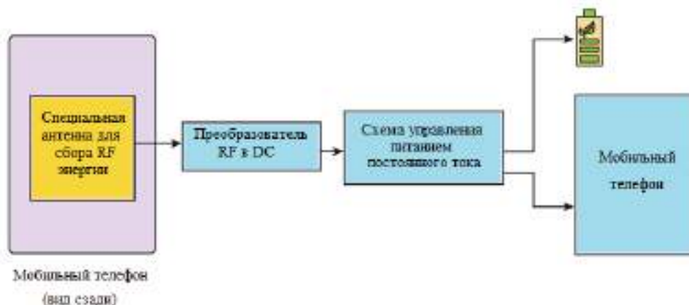
Рис. 1 Схема сбора и преобразования радиочастотной энергии в постоянный ток
