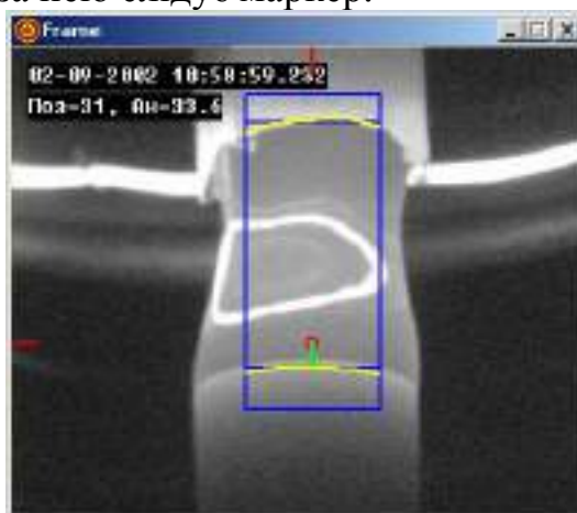
Рис. 1 Зона розплаву при проведенні електронно-променевої безтигельної зони плавки
