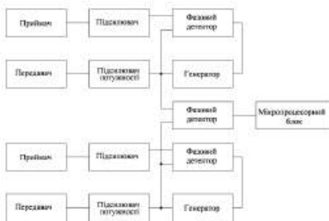
Рис. 1. Блок-схема мікропроцесорного ультразвукового витратоміра
