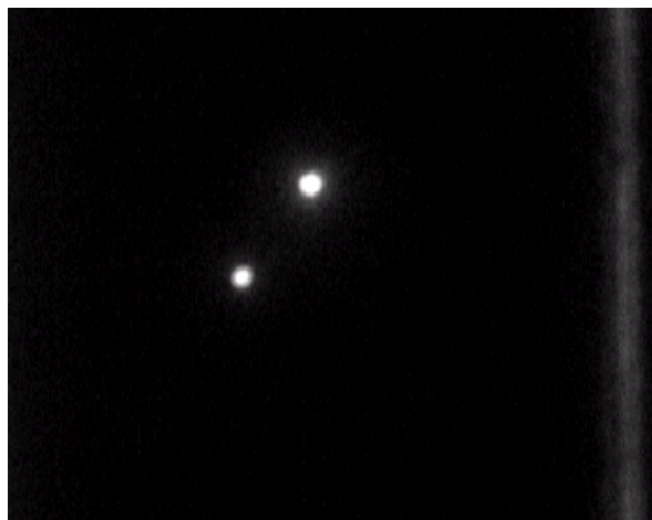
Рис. 1. Дефекти сонячного елемента, збільшення 50:1, розміри зображення 320 x 240 пікселів (2 x 1,5 мм)
